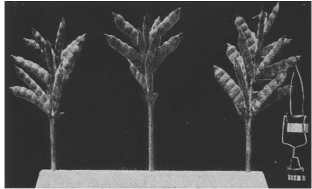
Abb. 32. Prüfungsmethode zur Feststellung der Bruchfestigkeit der Hülsen am Stielchen.
